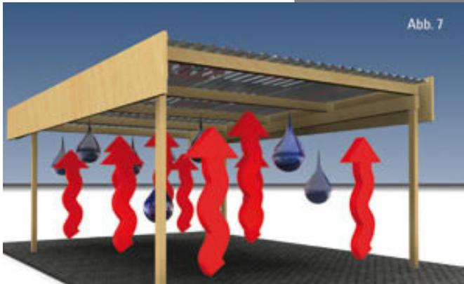
Feuchtigkeit steigt nach oben und bildet Kondenswasser. Ohne entsprechende Durchlüftung (Gewährleistung ausreichenden Luftstroms) tropft bei entsprechenden klimatischen Verhältnissen Wasser von Innendachflächen ab.
