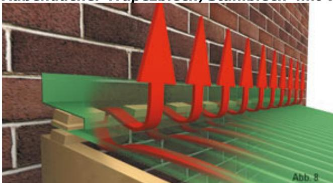
Überdachte Wandanbauten wie z. B. Terrassenüberdachungen entsprechend entlüften; Luftaustritt am Wandanschluss zur Vermeidung v. Kondensatwasserbildung unerlässlich; hinterlüftete Wandanschlüsse (auftragsbezogene Sonderkantteile – **Zubehörprogramm**)
