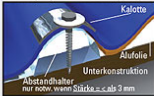
Querschnitt Befestigung vor der Überlappung
